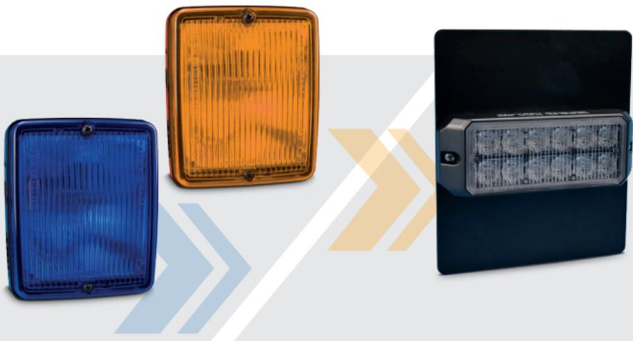
Rüsten Sie bestehende BSX Multi Frontblitzer von Hella mit diesem Umbausatz in wenigen Arbeitsschritten und ohne großen Aufwand anhand der bestehenden Verkabelung im Fahrzeug auf LED-Frontblitzertechnik um.
